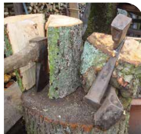
Unterschiedliche Festigkeit von gesundem (links) und vernarbtem Holz (rechts)
