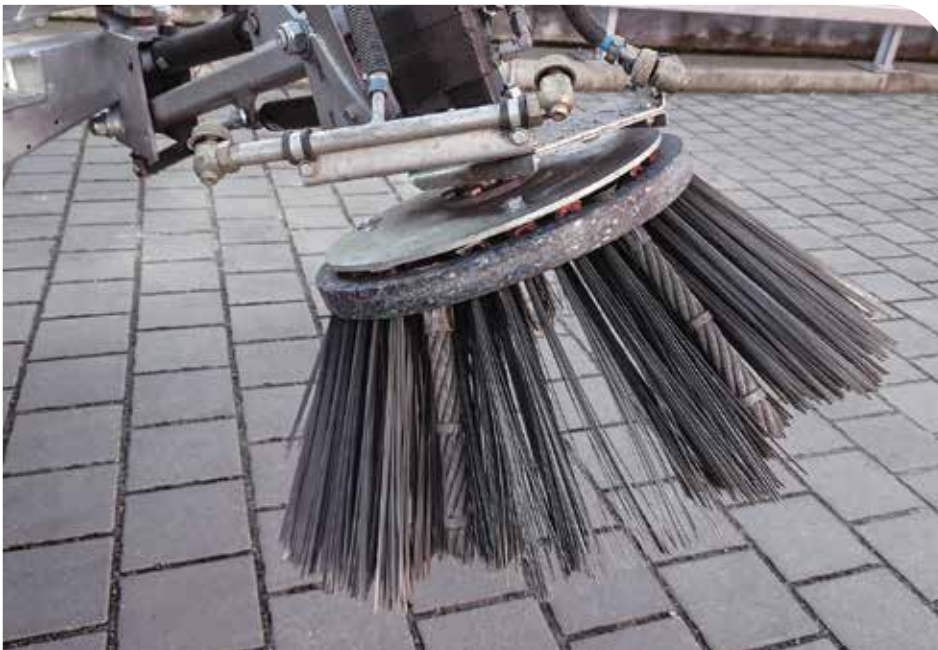
Neu: Die Wildkrautbürste besteht aus Drähten und Stahlseilen und wird gegen Unkraut und Bewuchs eingesetzt.
