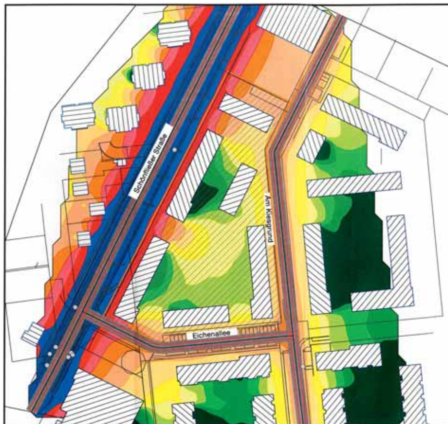
Entlang der Schönfließer Straße gibt es erheblichen Verkehrslärm. Bei Neubauten wird deshalb Schallschutz vorgesehen.
