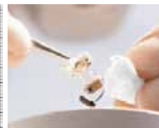
Einsatz von Verstärker- Chip, Lautsprecher & Mikrofon
